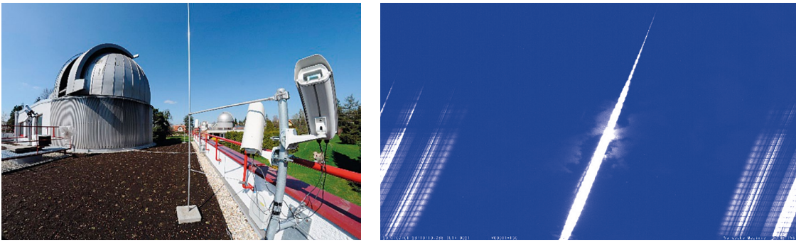
Obr. 2 Moderní spektrografy na Hvězdárně Valašské Meziříčí umožňují srovnat laboratorní spektra laserového ablačního plazmatu vzorků meteoritů se záznamem spekter plazmatu meteoritů. Daří se tak odhalit prvkové složení meziplanetární hmoty a vytvořit základní bázi poznatků pro experimenty vymezující aplikační potenciál laserové ablace v kosmonautice.
