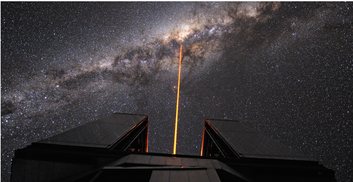
Obr. 9 Teleskop VLT ( Very Large Telescope ) Evropské jižní observatoře ESO v Chile, hledící do centra Mléčné dráhy. Laserový paprsek je součástí systému adaptivní optiky. Ve výšce asi 90 km vytvoří „umělou hvězdu“ o známé jasnosti, která slouží k přesným korekcím atmosférických vlivů na pozorování. Při detailním pohledu do centra Galaxie jsou vidět tmavá místa mezihvězdného plynu, která pohlcují viditelné záření. Proto se ke zkoumání samotného nitra naší Galaxie hodí více pronikající infračervené záření. Kredit: ESO
