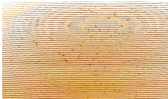
Obr. 2 Střední část hvězdného spektra zaznamenaného CCD detektorem ELODIE, spolu se spektrem thoria. Zakřivená posloupnost spektroskopických řádů spektru spolu s emisním spektrem thoriové lampy ozařující druhé optické vlákno.
