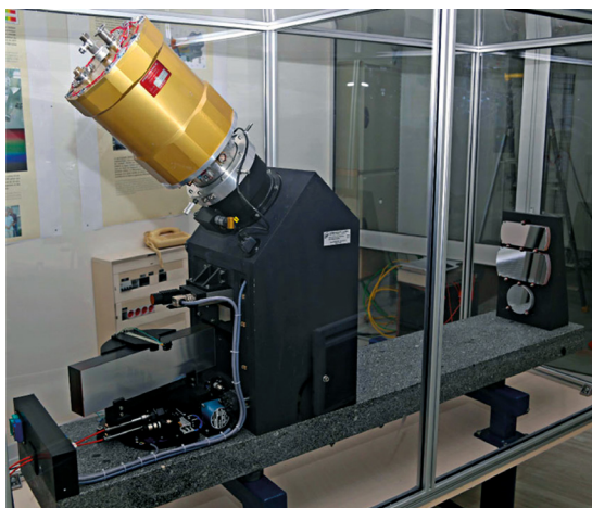
Obr. 1 Spektrograf ELODIE na observatoři OHP. Na levé straně je difrakční mřížka typu échelle. Optická vlákna (červená) přivádí signál do spektrometru. Nahoře je kryostat, v němž je umístěn CCD detektor. Optika se zkříženou disperzí je umístěna ve střední vertikální černé části.
