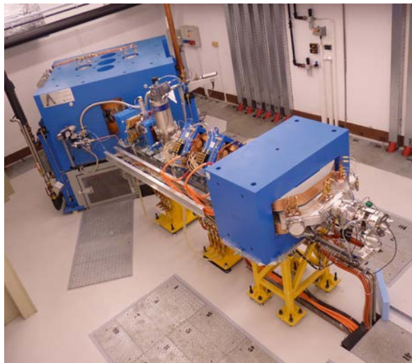
I na našem novém cyklotronu se buduje neutronový zdroj, který bude zkoumat reakce neutronů pro pokročilé štěpné i fúzní technologie (Foto ÚJF AV ČR).
