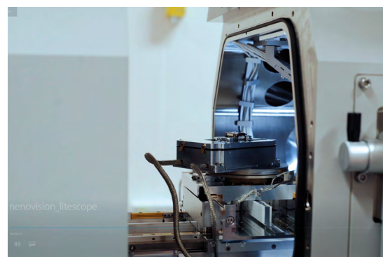
Obr. 8 LiteScope nainstalovaný do komory elektronového mikroskopu.
