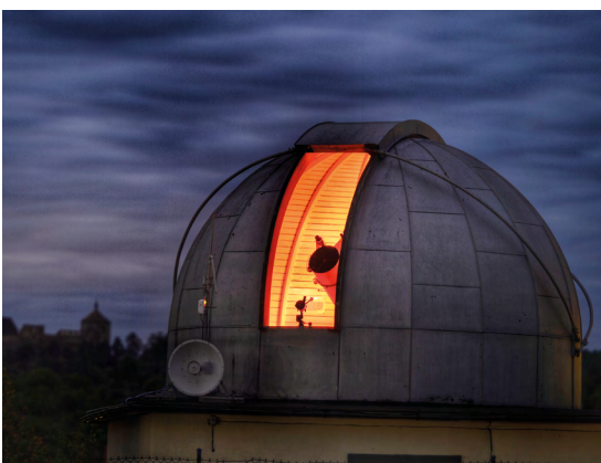
Obr. 1 Dalekohled typu Newton o průměru objektivu 0,358 m a ohniskové vzdálenosti 2,136 m je umístěn na speciální konstrukci, která je kopií vidlice amerického pětimetrového dalekohledu Hale na Mt. Palomar.
