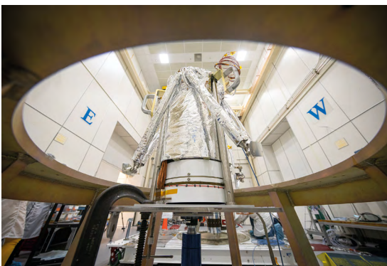
Obr. 4 Integrace systému DRACO (Didymos Reconnaissance and Asteroid Camera for Optical navigation), který bude autonomně navádět kosmickou loď ke srážce s Dimorphosem. Foto: NASA/Johns Hopkins APL/Ed Whitman
