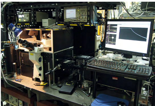
Obr. 2 Mikrospektroskopická aparatura s kryostatem – je to asi 5. generace mikrospektroskopie, kterou jsem vytvořil, je používána dodnes s různými vylepšeními. Foto z roku 2014
