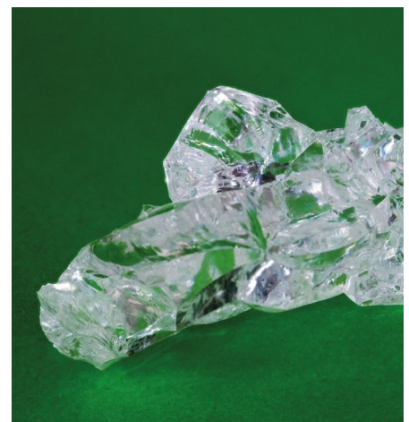
Obr. 7 Indukční tavení ve studeném kelímku lze využít i pro růst krystalů. Tomuto tématu se tým v Centru výzkumu Řež taktéž věnuje. Fotografie zachycuje nevybroušený krystal kubické zirkonie, která se hojně využívá ve šperkařství jako napodobenina diamantu.
