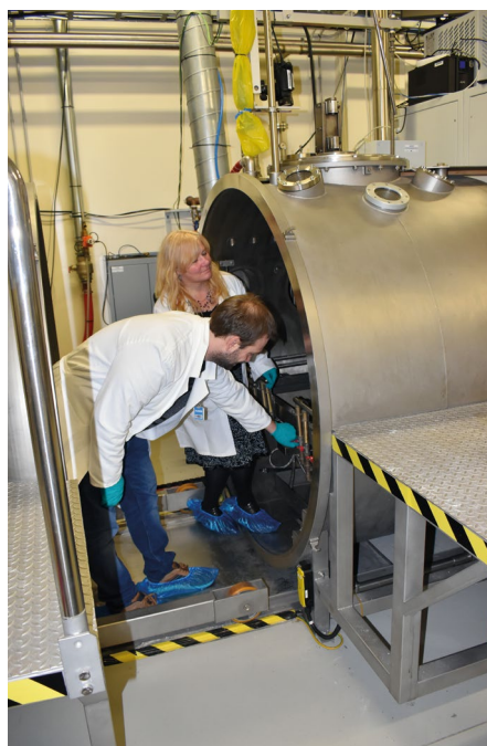
Obr. 2 V laboratoři probíhá experimentální studium dějů vznikajících při těžkých jaderných haváriích a dalších fyzikálních a chemických procesech, probíhajících za vysokých teplot (do 3 200 °C).
