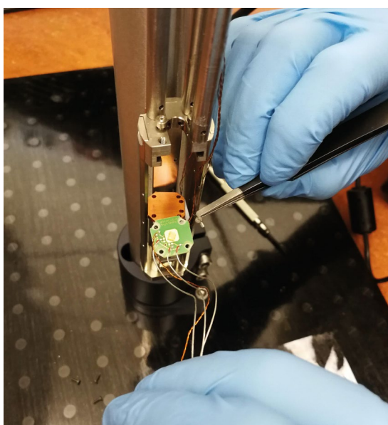
Obr. 1 Součástky pro spinkaloritroniku je třeba umístit do kryostatu. Dioscuri centrum se bude mimo jiné zabývat skenovací mikroskopií anomálního Nernstova jevu, při níž budou využity držáky vzorku jako na fotografii.
