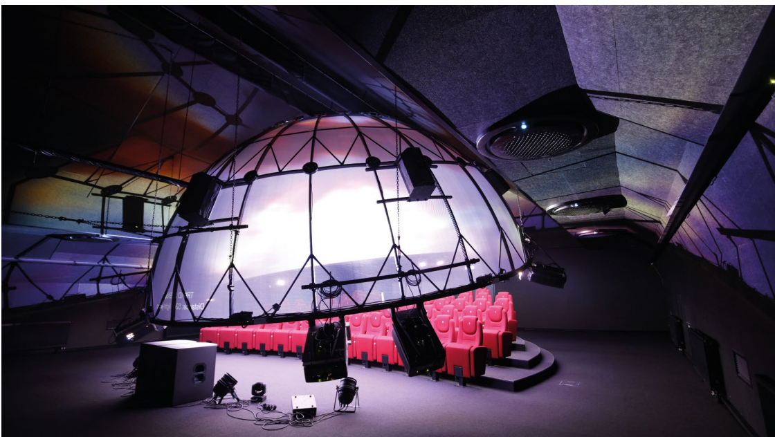
Obr. 1 Sférická projekce je tvořena zavěšenou bežešvou projekční kopulí o průměru 8 metrů a stupňovité auditorium je vybaveno 50 polohovacími křesly.
