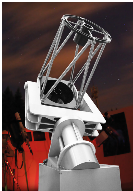
Obr. 5 Nástupce původního dalekohledu Newton – modifikovaný Argunov na vidlicové montáži 405/4000 mm s možností modifikace na 405/2400 mm. Označen zkratkou VL-KVT (Very Large Karlovy Vary Telescope). Instalován 2011–2013 zásluhou Města Karlovy Vary. Optika Vývojová optická dílna Turnov, mechanika SINCON Instrumental, Ing. Jan Lochman, Sedlisko, dokončení automatizace v roce 2015 Martinem Myslivcem, Běleč u Hradce Králové.
