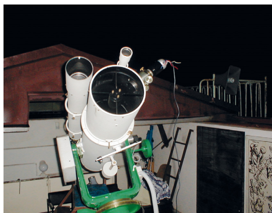
Obr. 9 Dalekohled Newton 250/1500 mm, označovaný jako KVT (Karlovy Vary Telescope), také přezdívaný Robotel. Jeho rekonstrukce po požáru hvězdárny v roce 1971 proběhla v letech 1975–1976. Roboticky byl dalekohled upraven v letech 1993–1999. Na snímku je v „podomáčku“ robotizované verzi v roce 2005. Využíváno pro webcast na stránkách www.astro-webcast.eu. Autoři projektu Pavel Kubíček, Aleš Leinweber, Miroslav Křížek a Miroslav Spurný. Robotické, poměrně přesné nastavování objektů jsme s úspěchem využívali pro veřejnost až do roku 2009, kdy jej nahradil dalekohled VL-KVT.
