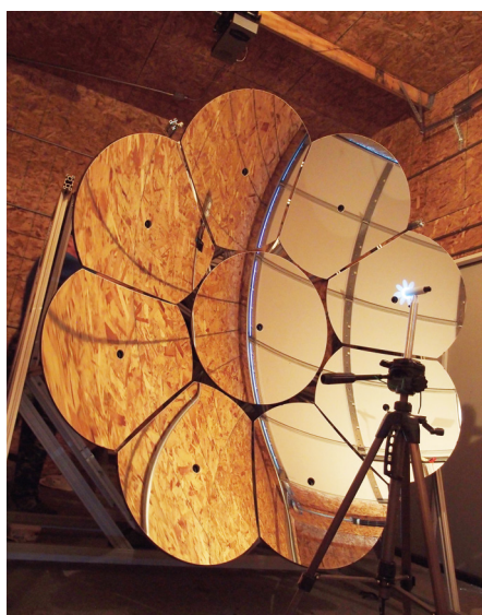
Obr. 1 Zrcadlový systém detektoru projektu FAST. Snímek justáže zrcadlového systému detektoru FAST – první prototyp.
