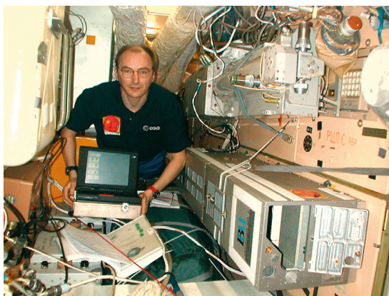
Obr. 3 Vesmírná aparatura TITUS na palubě orbitální stanice Mir během experimentu, který provádí francouzský astronaut Jean-Pierre Haigener (projekt MIR '99 – Perseus). Foto: CNES
