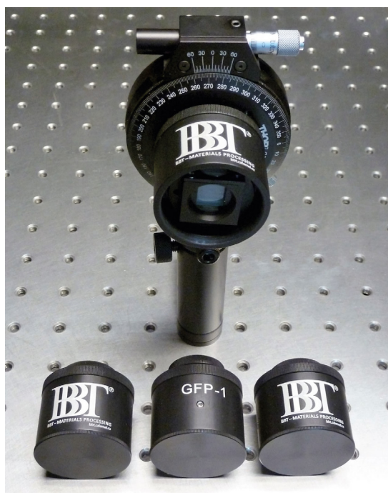
Obr. 6 Kalomelové polarizátory typu Glan-Foucault.
