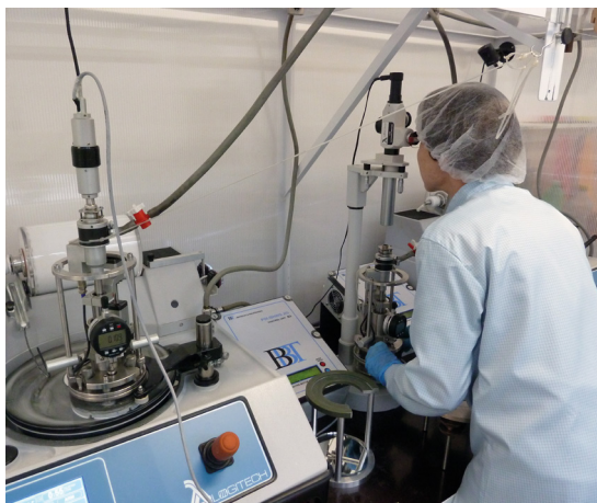
Pracoviště opracování monokrystalů na funkční optické komponenty.
