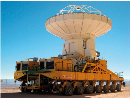
Obr. 2 Jednotlivé antény observatoře ALMA se prostřednictvím speciálních transportérů mohou po planině pohybovat a rozličně přesouvat do různých uskupení. Foto: Archiv ALMA
