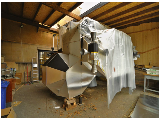
Obr. 4 Vzletový modul bylo třeba vytvořit najednou, aby skutečně co nejpřesněji imitoval LEM. Foto: Archiv Planetum
