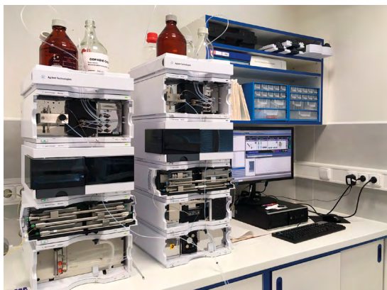
Obr. 4 Kapalinové chromatografy s detektorem s diodovým polem, fluorescenčním a refraktometrickým detektorem.
