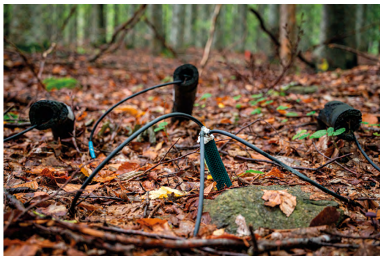
Obr. 7 Půdní tenzometry v povodí Liz na Šumavě. Tato zařízení jsou důležitá pro monitorování půdní vlhkosti, zejména v situacích, kdy je potřeba řídit závlahu nebo studovat interakci rostlin s půdou.
