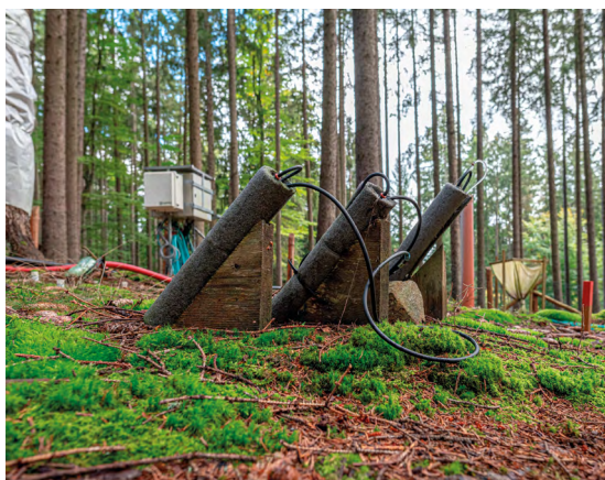
Obr. 9 Komplexní monitoring srážkoodtokového systému v experimentálním povodí Liz na Šumavě umožňuje nejen sledovat množství vody v půdě, ale také efektivitu jejího využití rostlinami – v tomto případě smrkovým lesem.
