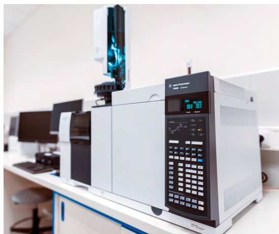
Obr. 5 Plynový chromatograf sloužící k detekci především těkavých organických mikropolutantů ve zdrojích surové i pitné vody.
