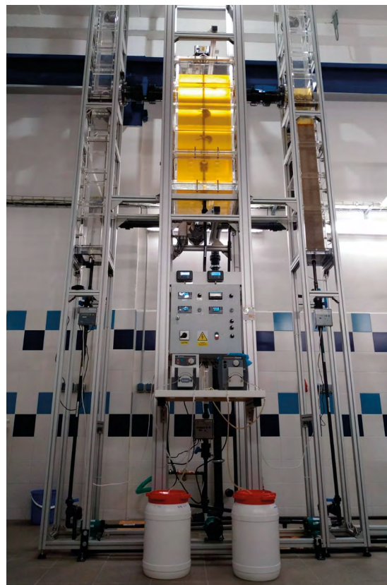
Obr. 8 Poloprovozní model na úpravě vody v Kutné Hoře. Zařízení slouží k výzkumu vlivu fyzikálně-chemických podmínek na koagulaci (proces odstraňování znečišťujících příměsí pomocí tzv. koagulačních činidel – nejčastěji soli Al a Fe).
