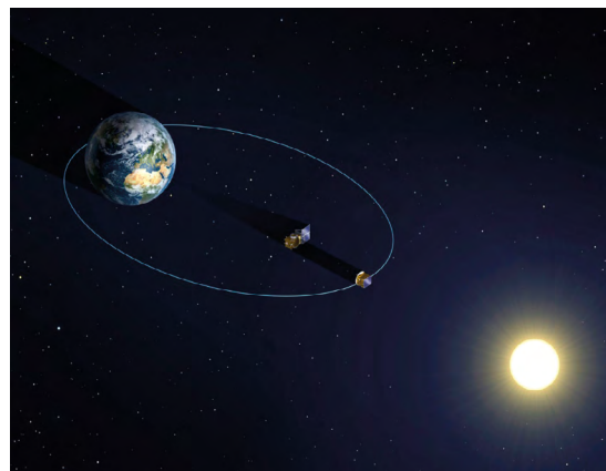
Obr. 2 Mise Proba-3 je jedinečná tím, že disk, který zastiňuje Slunce, a dalekohled jsou na dvou různých družicích, a tedy daleko od sebe. Zdroj: ESA
