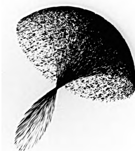
Při natáčení starého objektivu se výrazně projevil koma a celá vlnoplocha je prostorově ovzorkovaná jevem koherenční zrnitosti (speckle).
