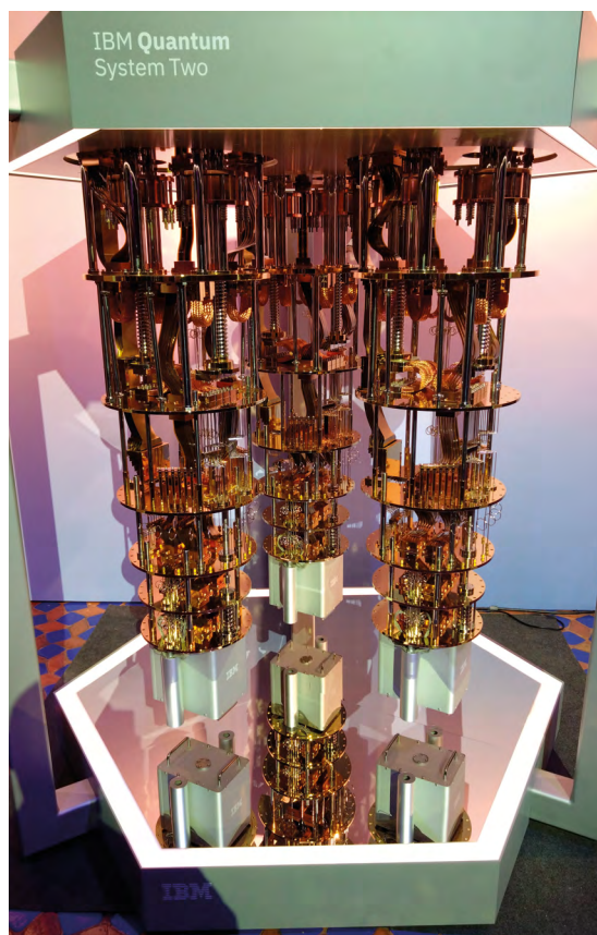
Obr. 15 Model jednoho z nejmodernějších počítačů firmy IBM, který se nazývá System two a skládá se ze tří jednotek s tím, že v každé je 133 qubitů.
